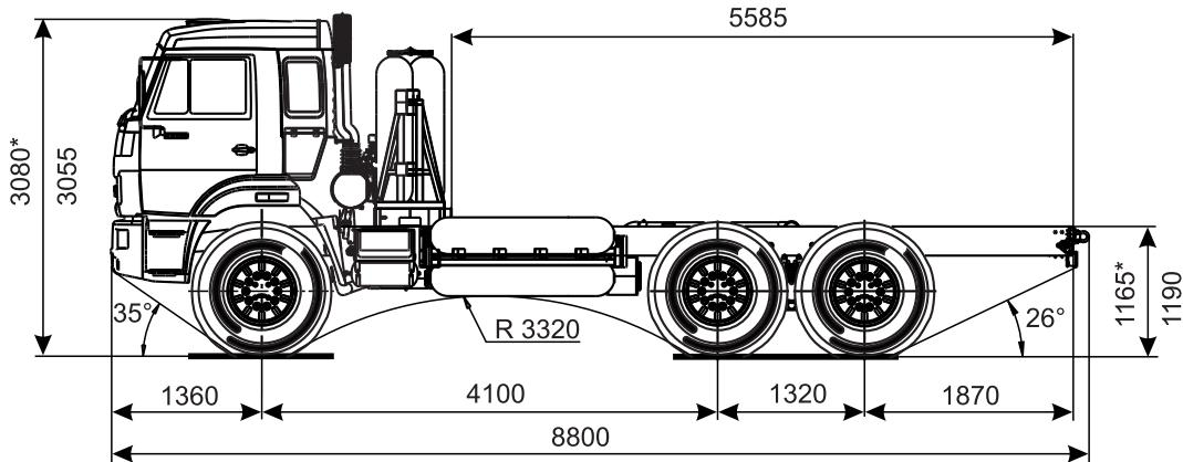
Размеры даны для автомобиля в снаряженном состоянии.
