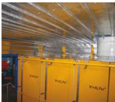
Блок емкостей из нержавеющей стали
