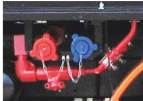
Присоединение через быстроразъемные соединения
